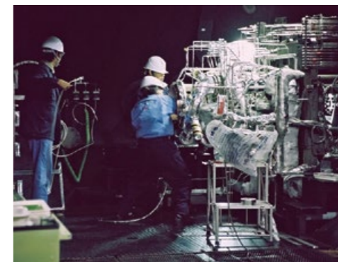
H-II/B ロケット 3号機 LE-5B-2 エンジン領収燃焼試験 (角田宇宙センター) (c) JAXA
