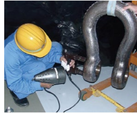
非破壊検査 (磁粉探傷検査)
