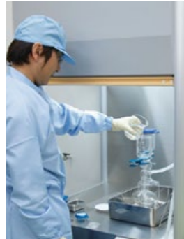
ロケット系清浄度分析作業
