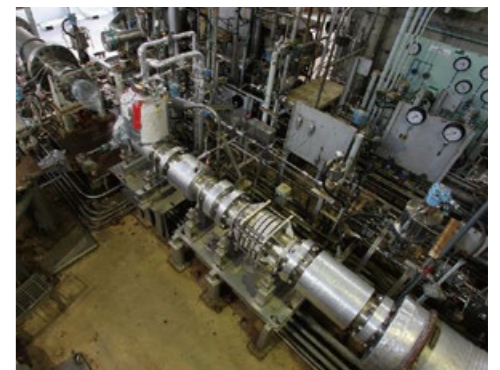
高圧液酸ターボポンプ試験設備 (角田宇宙センター) (c) JAXA
