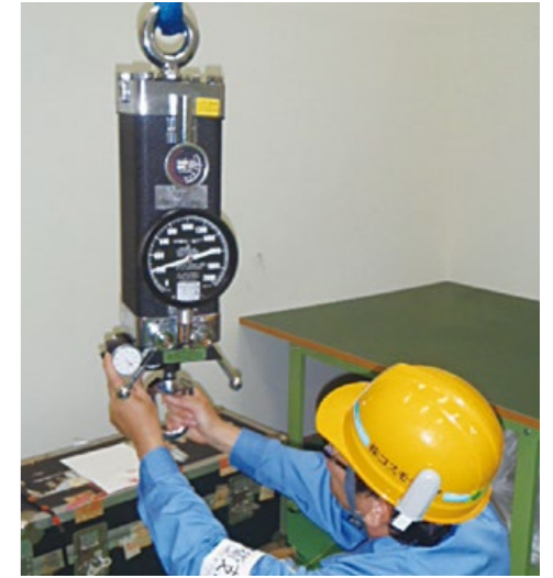
ハイドラセット点検室 点検作業
