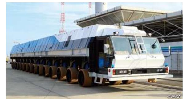
H3ロケット用新型移動発射台運搬台車
